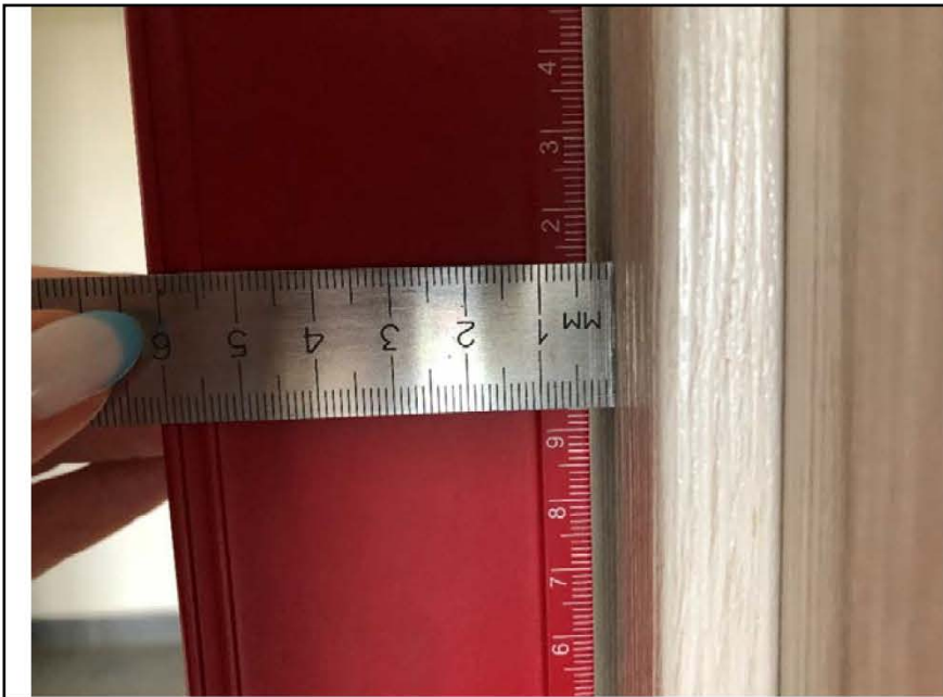
Фото №7. Измерение уровня наличника дверного блока в санузле.
